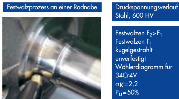
Bild 17: Festwalzen von Oberflächen
