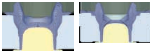
Bild 15. Auswertung des Faserverlaufs in einem Schmiedeteil mit Hilfe der Umform-FEM-Prozesssimulation
