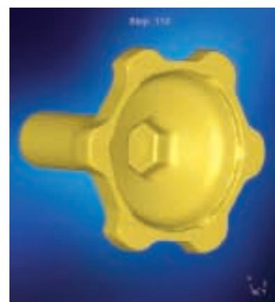
Bild 30: Entstehung einer Materialüberlappung an einem Flanschteil
