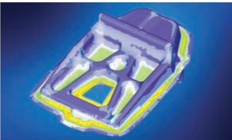
Bild 27: Umformgrad an einem Seitenleitwerksbeschlag
