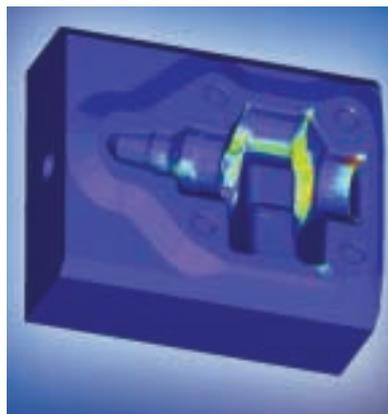
Bild 23: Maximale Druckspannung innerhalb des Werkzeugs einer 2-Zylinder-Kurbelwelle
