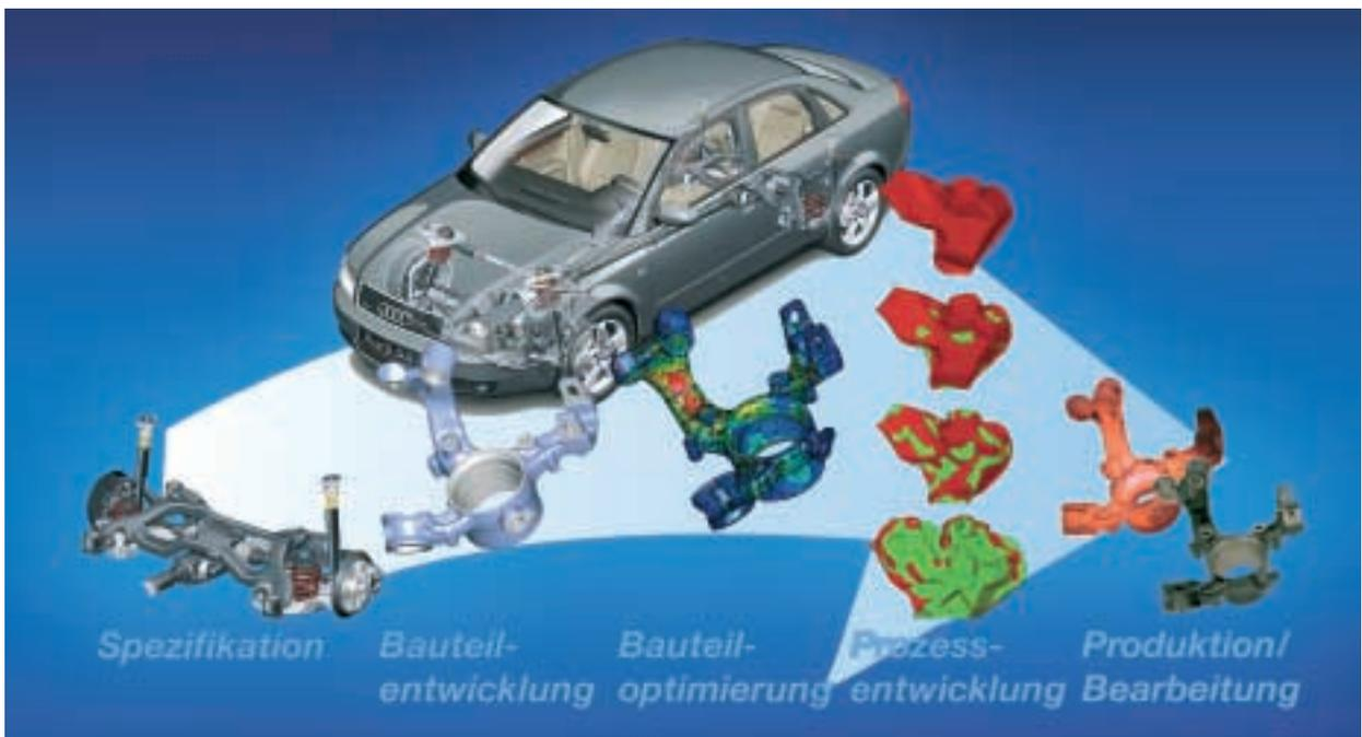
Bild 2: Entwicklungskette vom Lastenheft/Bauraum über CAD/FEM-Einsatz zum Werkzeug und zur Produktion
