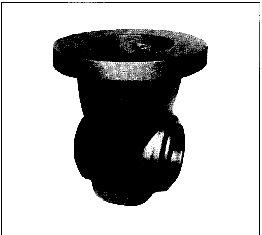
Bild 4: Hohlgedorntes Gehäuse für Absperrschieber DN 150 PN 100 (58 kg) aus 13 CrMo 4 4
