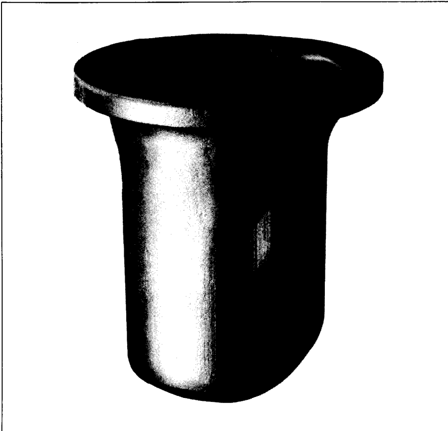
Bild 5: Rückwärts-warmfließgepreßtes Gehäuse für Absperrschieber DN 300 PN 100 (206 kg) aus C 22.8
