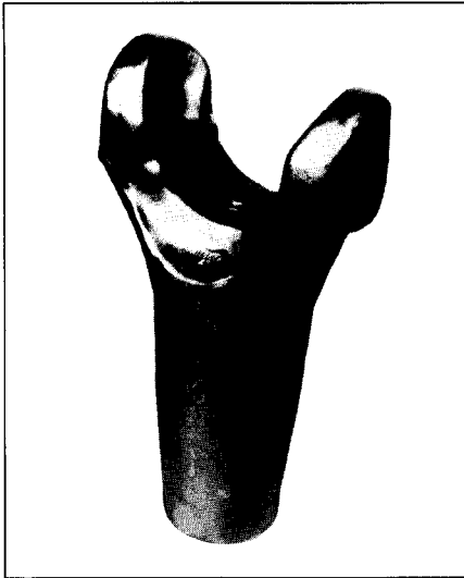
Bild 19: Gesenkgeschmiedeter Wellenmitnehmer (61,0 kg) aus 42 CrMo 4 V
