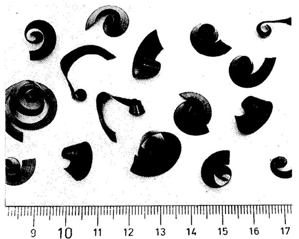
Werkstückstoff: C 38 mod. BY    Arbeitsgang: Vollbohren (kleines Auge)
