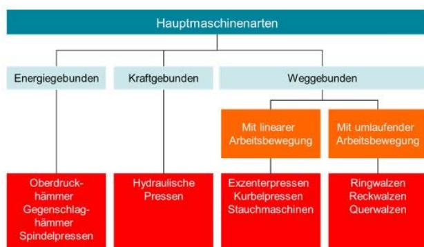
Bild 4: In der Massivumformung kommen drei verschiedene Maschinenarten zum Einsatz: Energiegebunden – Kraftgebunden – Weggebunden.
