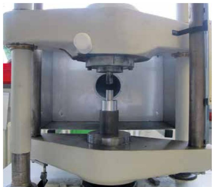
Bild 3: Aufbau des Einpresstests bei der FUCHS LUBRITECH GmbH
