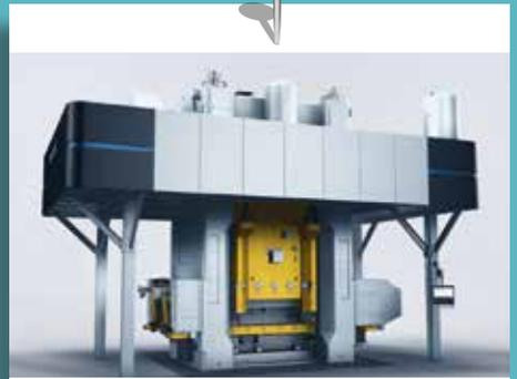
Eine Schuler-Kurbelschmiedepresse vom Typ PK 3150 fertigt künftig bei OTTO FUCHS in China Aluminium-Fahrwerksteile, Bild: Schuler
