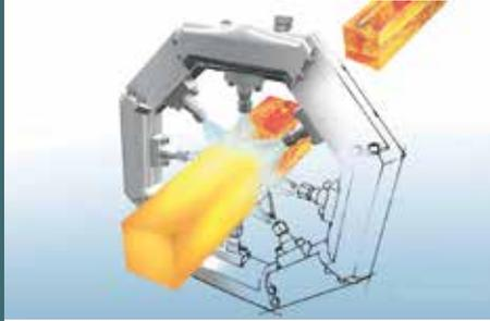
Die patentierten DÜV-Düsenventile geben den Druck von bis zu 320 bar nur frei, wenn sich ein Werkstück im Wirkungsbereich des Spritzrings befindet, Bild: SGGT Hydraulik GmbH
