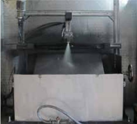
Bild 1: Sprühstand für den Benetzungstest
