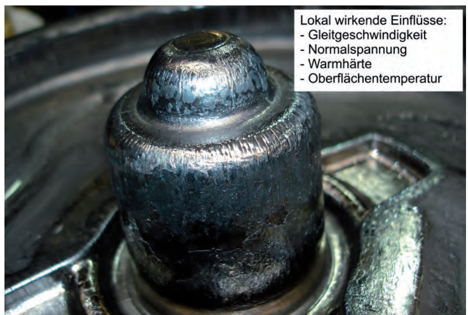
Bild 1: Verschleiß, Rissbildung und plastische Verformung an einem Schmiedewerkzeug.
